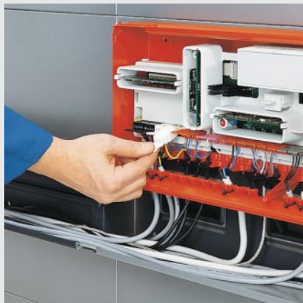
Einheitliche Stecker-codierung im gesamten Vitotronic Programm
